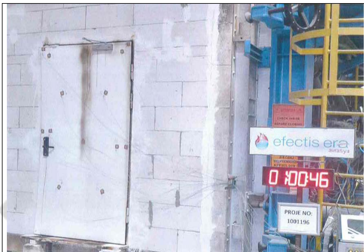
شکل الف-۲: سمت غیر در معرض آزمون در دقیقه ۶۰ام آزمون
