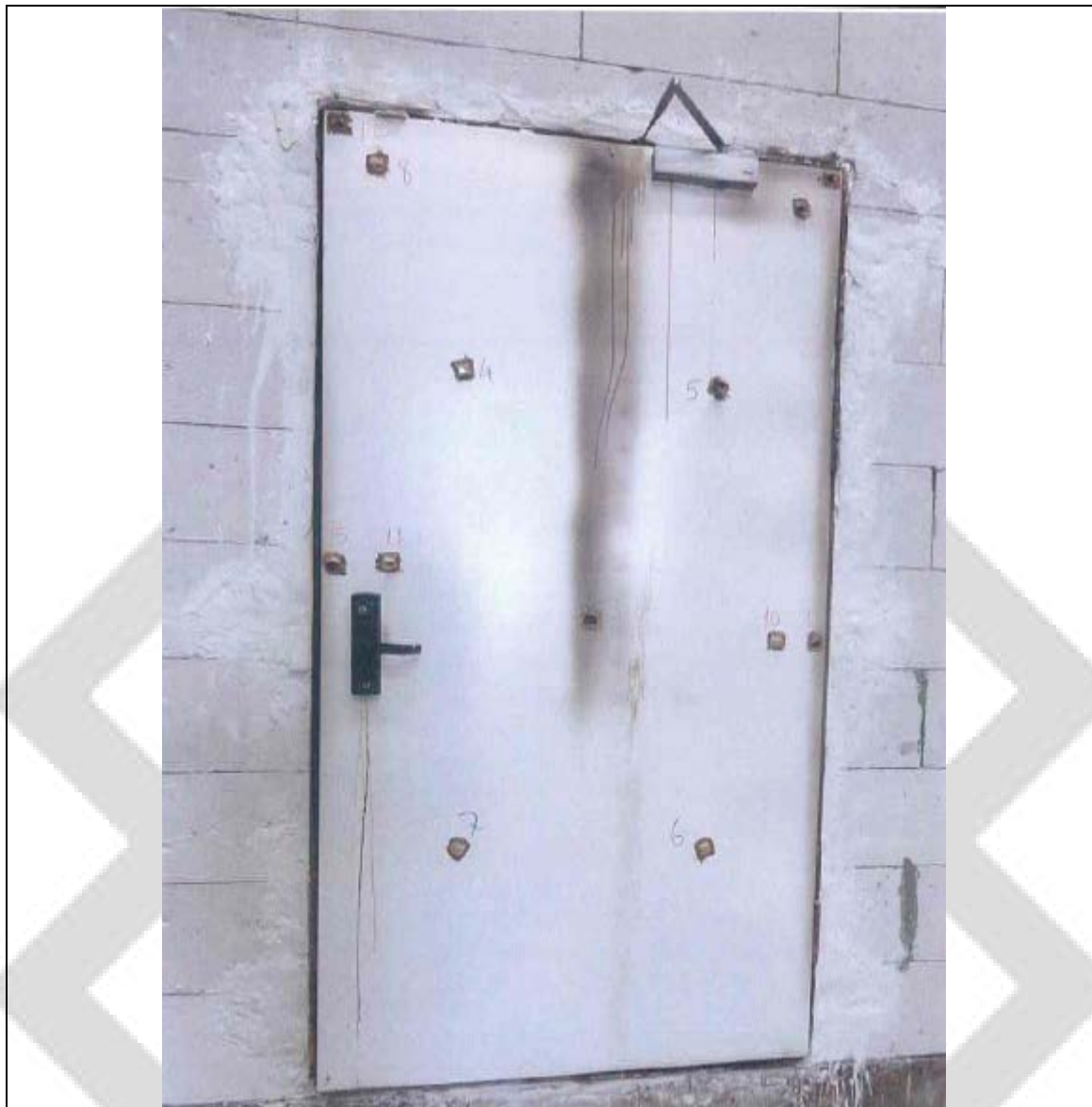
شکل الف-۳: سمت غیر در معرض نمونه پس از آزمون
