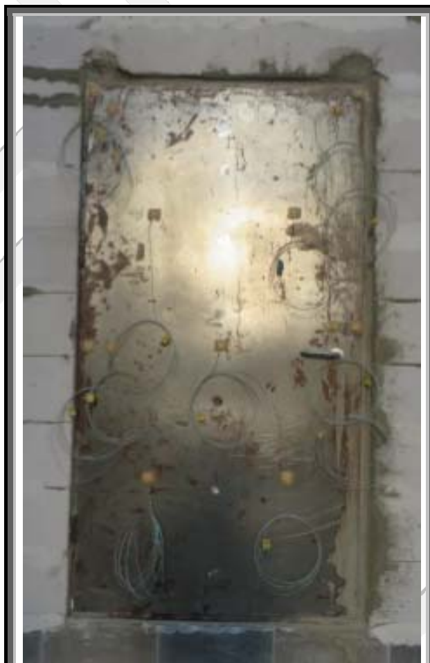
شکل الف-۱: سمت غیردر معرض آتش قبل از آزمون
