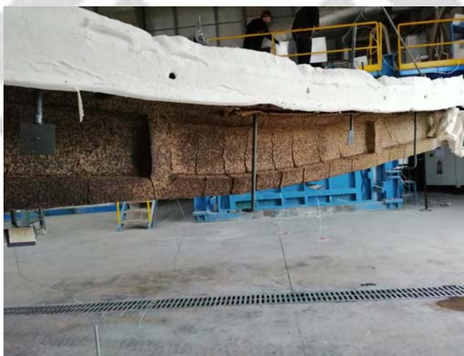
شکل ۴: تیر تحت بار مقیاس کامل ضخامت حداکثر
