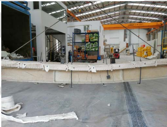
شکل ۳: تیر تحت بار مقیاس کامل ضخامت حداقل
