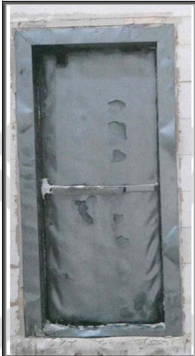
شکل الف-۴: سمت در معرض حریق پس از آزمون
