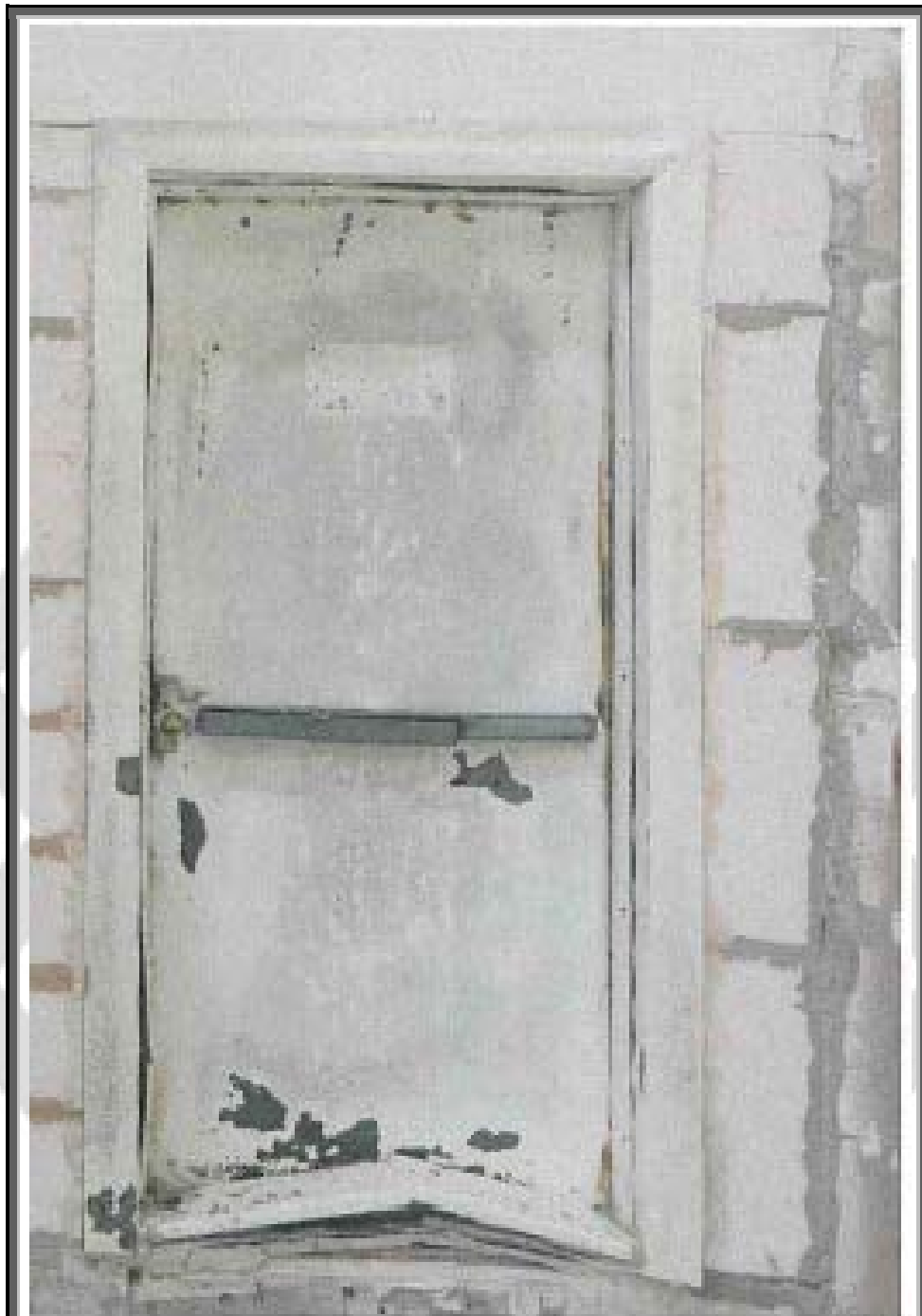
شکل الف-۴: سمت در معرض حریق پس از آزمون
