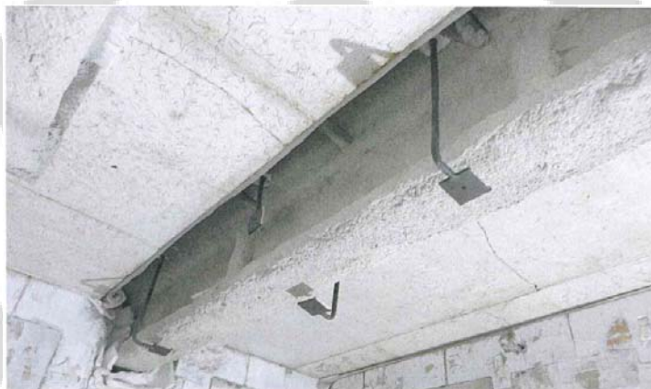
شکل ۳: تیر تحت بار مقیاس کامل قبل از آزمون
