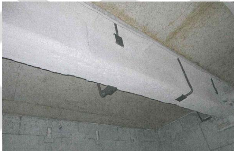
شکل ۳: تیر تحت بار مقیاس کامل قبل از آزمون
